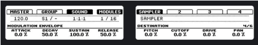
La zone MODULATION ENVELOPE du Sampler sur le contrôleur.
