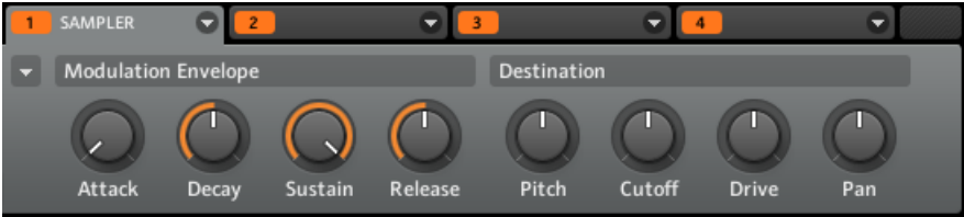
La zone Modulation Envelope du Sampler dans le logiciel.
