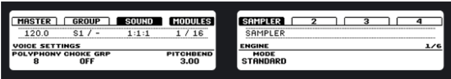
La zone VOICE SETTINGS du Sampler sur le contrôleur.
